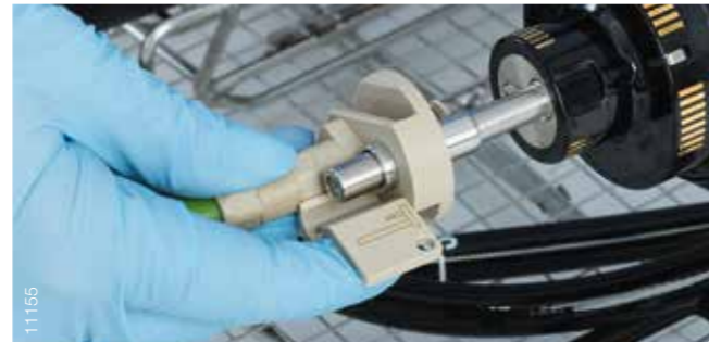
Mechanisch kodierte Adapter mit lasergraviertem Bildsymbol.
